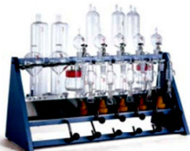
Рис. 37 - Аппарат для определения серы ламповым методом модели 20410-0 фирмы Stanhope-Seta
