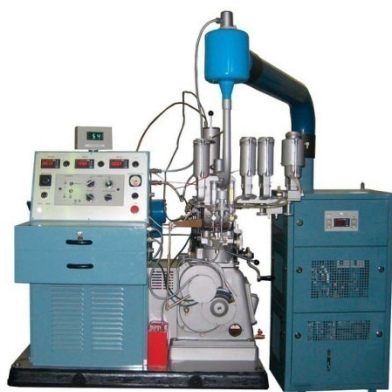
Рис. 15 - Универсальная установка УИТ85 для определения ОЧ по моторному и исследовательскому методам
